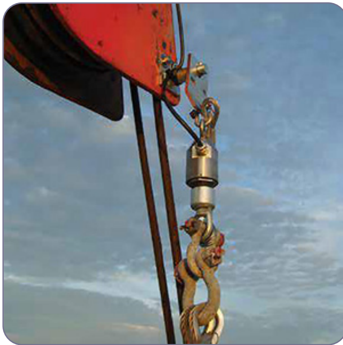
شکل ۵-۸. سوییچ قطع کن الکتریکی بر روی قرقره انتهای بوم
