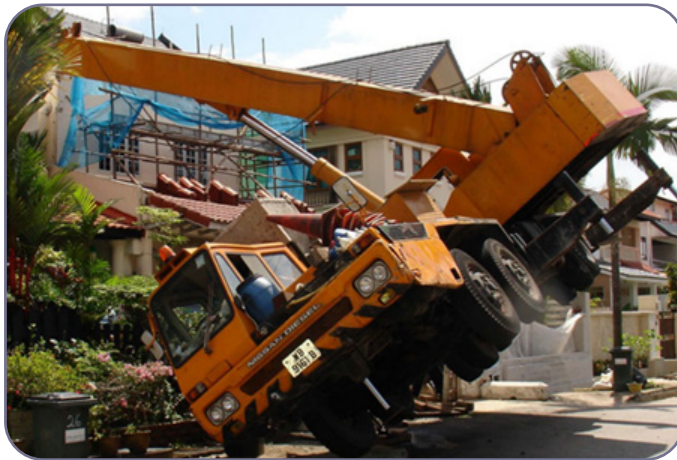
شکل ۵-۵. واژگونی جرثقیل متحرک به دلیل استفاده ناصحیح از جک‌های تعادلی
