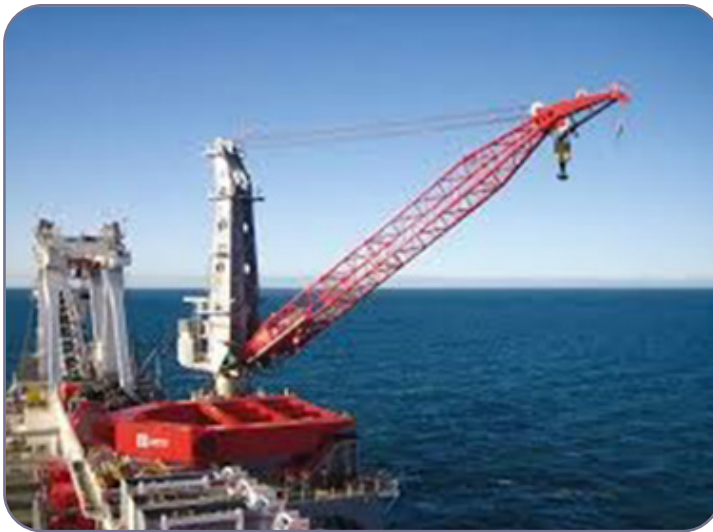
شکل ۲-۲۱. جرثقیل پایه ثابت
