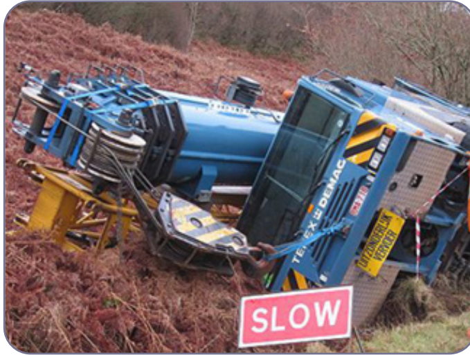
شکل ۶-۵. واژگونی جرثقیل متحرک در هنگام جابجایی
