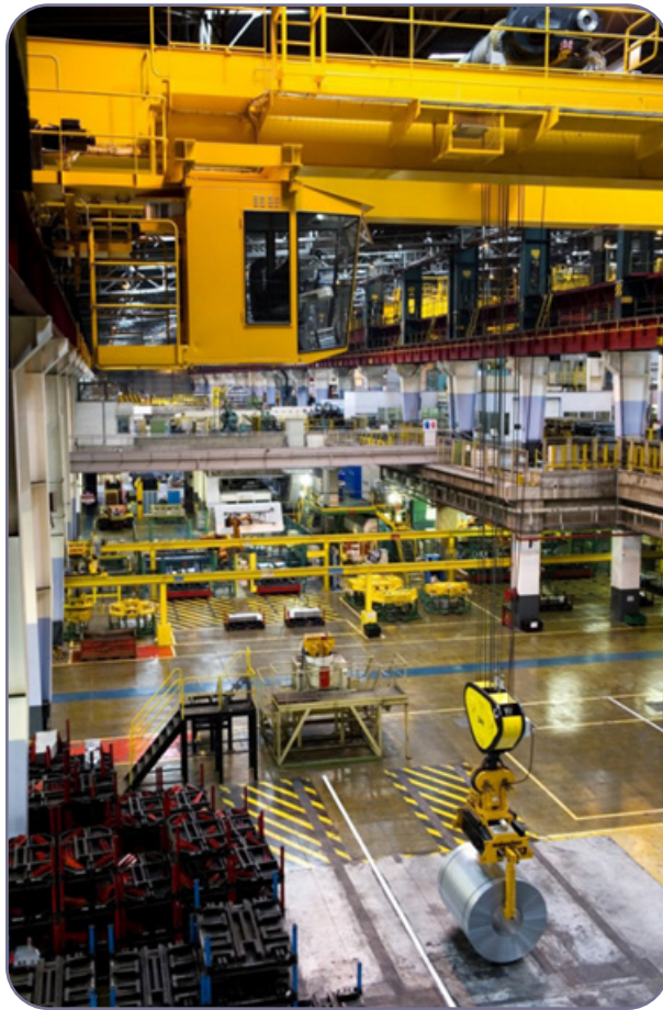
شکل ۱۳-۲. جرثقیل سقفی در حال بلند کردن بار در محیط کارخانه
