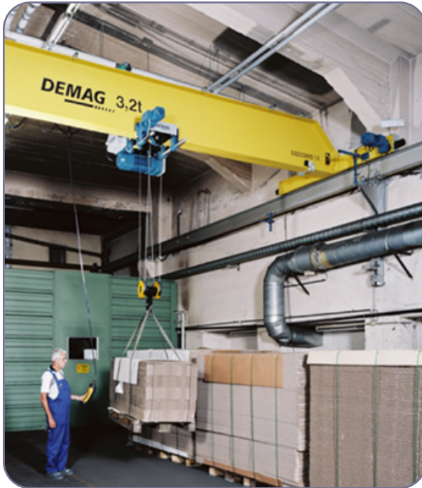
شکل ۱۵-۲. کاربر در حال هدایت جرثقیل سقفی توسط صفحه کلید آویز
