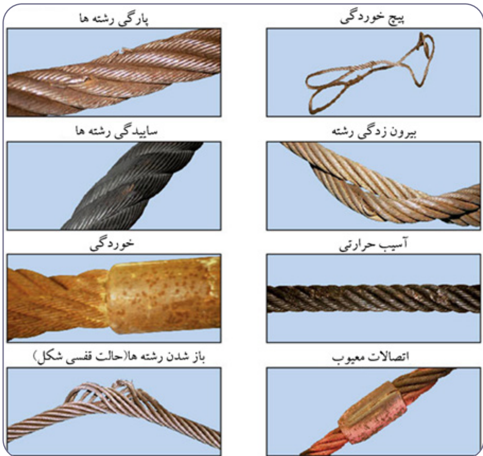
شکل ۴-۴. عیوب سیم‌بکسل‌ها
