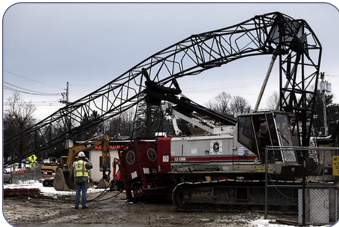
شکل ۷-۵. تغییر شکل بوم مشبک در اثر گیرکردن قلاب به قرقره انتهایی بوم
