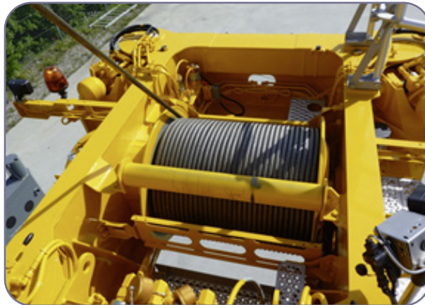
شکل ۳-۳. وینچ جرثقیل متحرک
