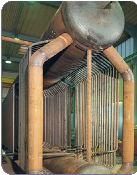
شکل ۲-۵ ساختار فلزی دیگ لوله آبی
