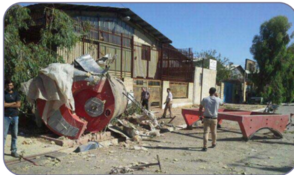
شکل ۱۴-۶ انفجار به دلیل دیگ غیر استاندارد در شیراز
