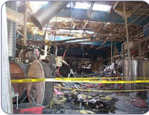
شکل ۱۵-۶ انفجار به دلیل دیگ غیر استاندارد در یزد
