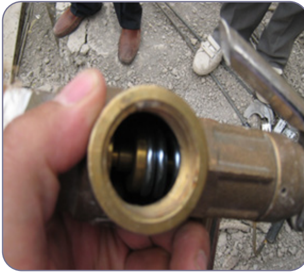
شکل ۱۳-۶ سوپاپ اطمینان معیوب
