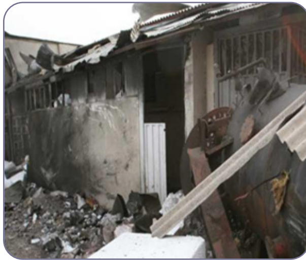
شکل ۱۲-۶ انفجار دیگ به دلیل عمل نکردن سوپاپ
