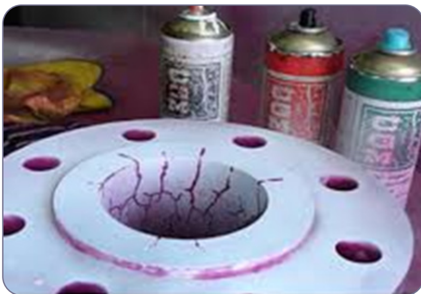
شکل ۴-۴. نمونه قطعه معیوب در تست مایع نافذ
