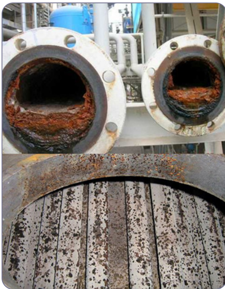
شکل ۳-۳ نمونه‌هایی از خوردگی و رسوب در لوله‌های دیگ بخار
